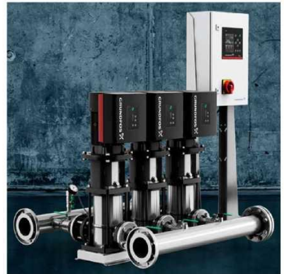
그림 3: 속도 제어를 통합하여 신속하게 처리량을 늘리거나 줄이는 패키지형 부스터 시스템은 일반적으로 편흡입 또는 분할 케이스 펌프가 제공하는 것보다 더 큰 에너지 효율로 광범위한 수요를 충족할 수 있습니다.
