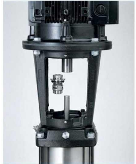
그림 2: 쉽게 교체할 수 있는 카트리지를 채택하여 모터를 분리할 필요 없이 이 입형 다단 원심펌프의 메커니컬 씬을 수 분 내에 쉽게 교체할 수 있습니다. 이로써 일반적으로 장축의 편흡입 펌프 및 분할 케이스 펌프의 씬 교체 후 모터 및 샤프트 재정렬과 관련된 시간과 노력을 들이지 않아도 됩니다.
