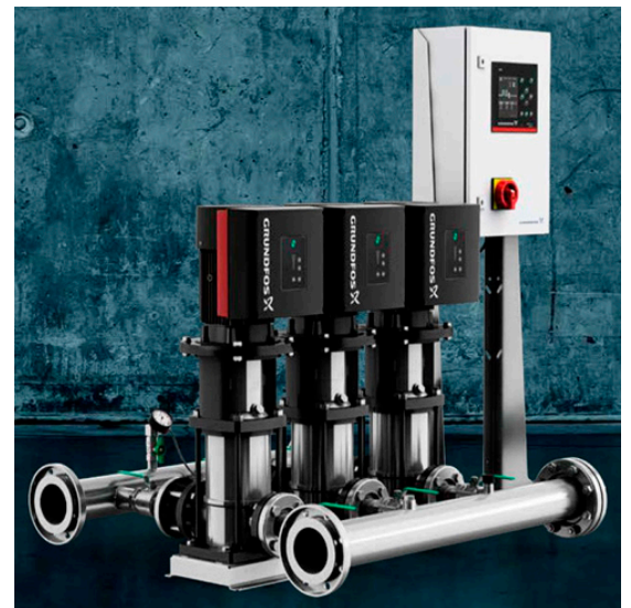
รูปที่ 3: ระบบชุดปั๊มหลายตัวที่มีระบบการควบคุมความเร็วสำหรับเพิ่มหรือลดระดับอย่างรวดเร็ว สามารถตอบสนองความต้องการที่หลากหลายกว่าพร้อมประสิทธิภาพการประหยัดพลังงานที่มากกว่าปั๊มคู่ปลายหรือปั๊มแยกตัวเรือนทั่วไป
