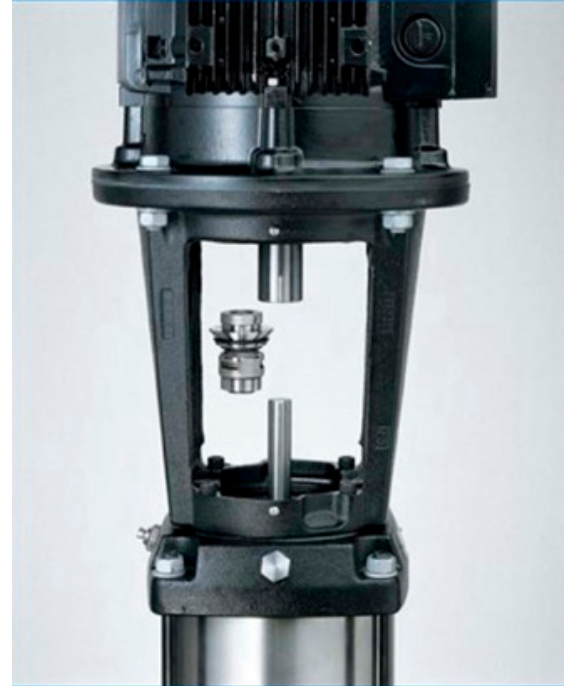
รูปที่ 2: ดัดแปลงที่เข้าถึงได้ง่ายช่วยให้สามารถเปลี่ยนซีลกลสำหรับปั๊มหลายใบพัดแนวตั้งได้อย่างง่ายดายในเวลาไม่กี่นาทีโดยไม่ต้องถอดมอเตอร์ วิธีนี้จะช่วยลดเวลาและภาระงานซึ่งมักจะมาพร้อมการตั้งศูนย์มอเตอร์และเพลลาใหม่ หลังการเปลี่ยนซีลบนปั๊ม End Suction แบบต่อยาวและปั๊ม Split Case
