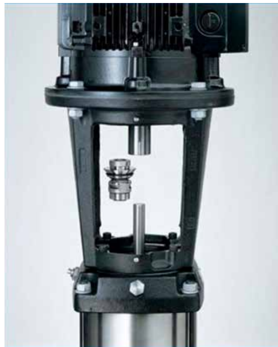
圖 2：使用易於拆換的卡匣，無需拆卸馬達即可在幾分鐘內完成此立式多段離心泵浦的機械式密封更換作業。透過這項設計，長聯結軸泵浦與分件式泵浦在完成密封更換作業後，便可免除傳統上重新軸封與馬達校心的需要。
