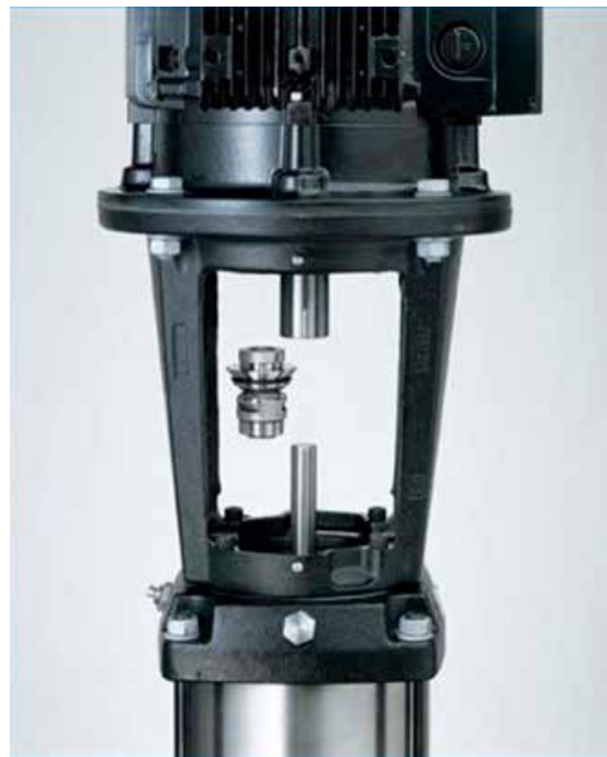
Figura 2: Un eje mecánico con cierre tipo cartucho de una sola pieza y fácil acceso puede sustituirse en apenas unos minutos sin tener que retirar el motor. Así se ahorra el tiempo y esfuerzo normalmente asociados a la realineación de motores y ejes tras la sustitución de los cierres en el caso de bombas de aspiración final y acoplamiento corto o de carcasa dividida.
