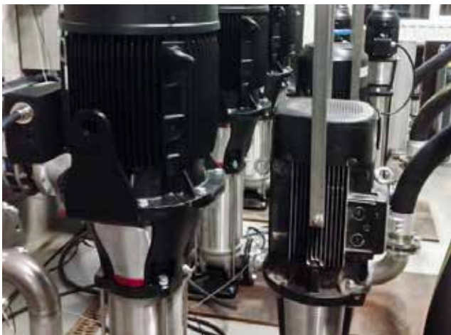
Pruebas de campo de la serie CR95-CR 185 en el departamento de I+D de Grundfos.
