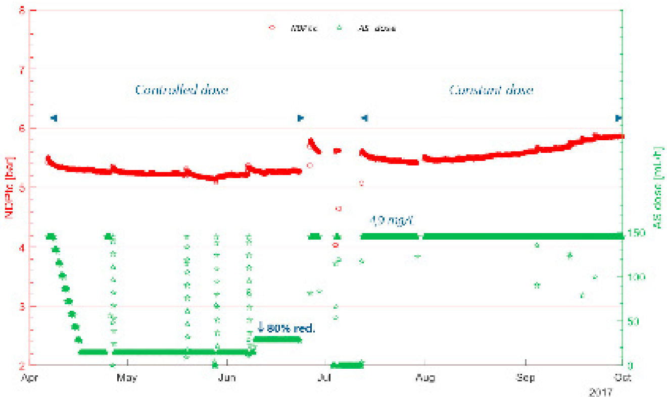
2. ábra: A Smart RO-t használó (szabályozott dózis) és a Smart RO (állandó dózis) nélküli rendszer összehasonlítása
