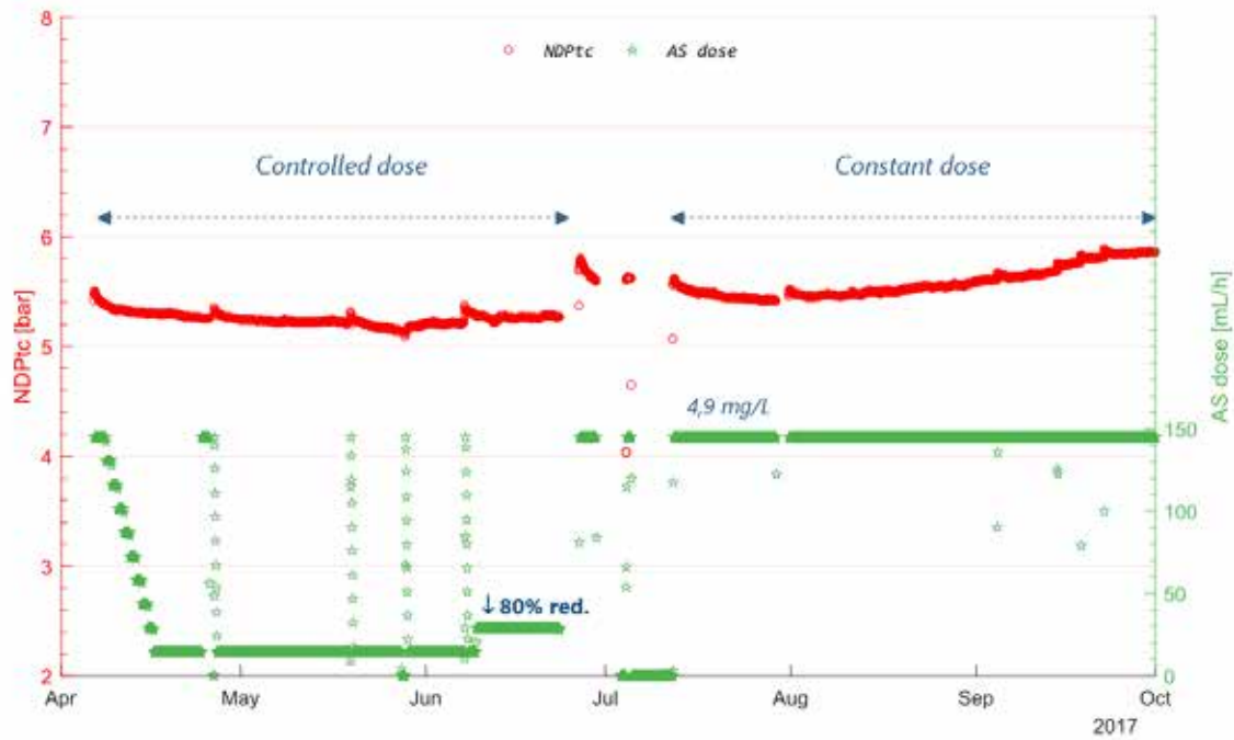
图 2: 采用智能 RO (受控剂量) 和不采用智能 RO (恒定剂量) 运行的系统之间的对比
