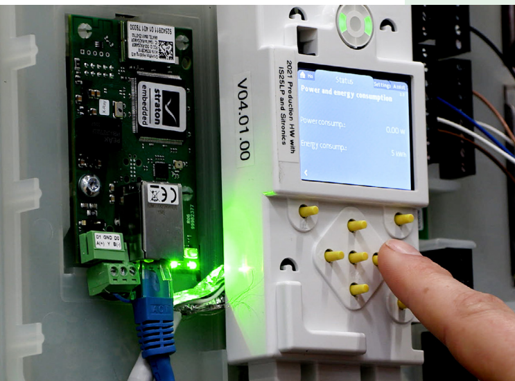
Grundfos Soft PLC-kort ger ett mer digitalt, datadrivet pumpsystem, vilket eliminerar behovet av extern PLC och sparar betydande energi- och CO 2 -utsläpp.
