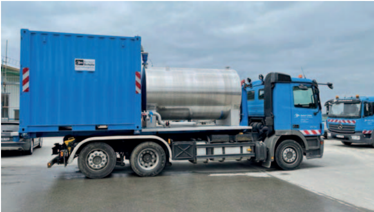
Mobile DEA mit Container und Wasserbehälter mit 10 m 3 Fassungsvermögen. Die komplette Pumpentechnik ist immer einsatzbereit an „Bord“.
