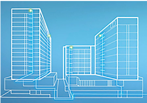
Ein Beispiel für ein Gewerbegebäude mit einem großflächigen Wassersystem. Den kritischen Bereich zu bestimmen, kann schwierig sein. Um das ganze System abzudecken, können bis zu sechs Sensoren installiert werden.
