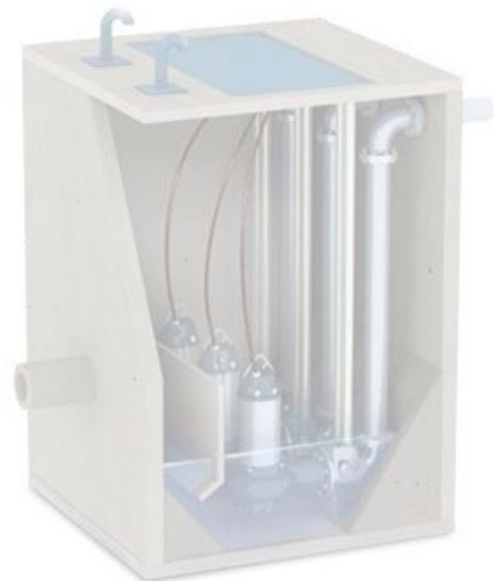
Figure 5 : Station de pompage rectangulaire
