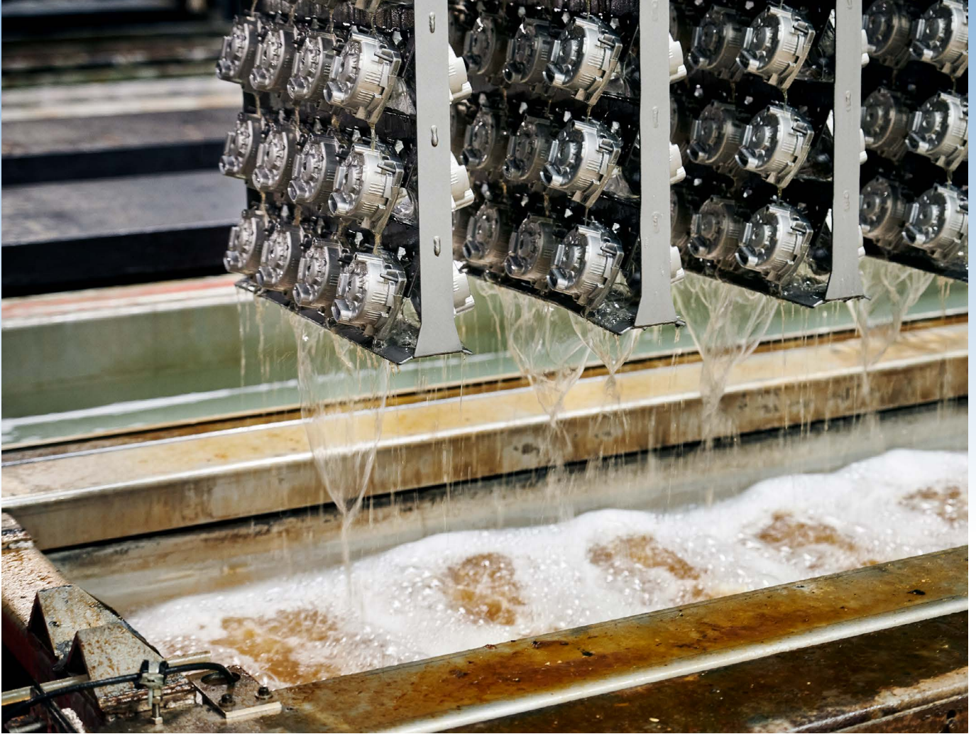
新しいダイキャスト部品のラックが、ビエリングプロのGrundfos工場にあるCED表面処理システムの、最初のリンスプールから引き揚げられています。
