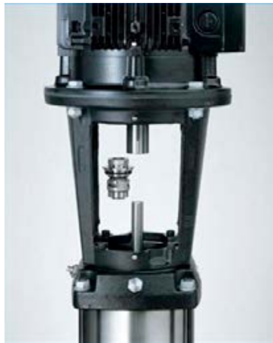
Afbeelding 2: Een gemakkelijk toegankelijke cartridge voor de mechanische asafdichting uit één stuk kan in enkele minuten worden vervangen, zonder de motor te hoeven verwijderen. Dit voorkomt de tijd en moeite die gewoonlijk gepaard gaan met het opnieuw uitlijnen van motoren en na het vervangen van de afdichting bij normblokpompen op fundatieplaat en split-case pompen.
