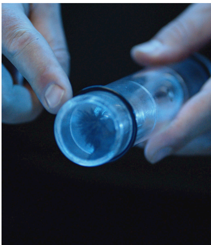
Standard akslinger i stål – tiltrekker seg magnetitt
