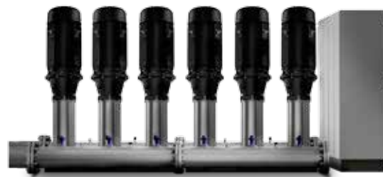
Figura 3: Os grupos hidropressores com variação de velocidade para aumentar ou diminuir o caudal podem satisfazer uma maior variedade de necessidade de caudal com uma eficiência energética superior à que é normalmente oferecida por bombas de aspiração axial ou de câmara bipartida.
