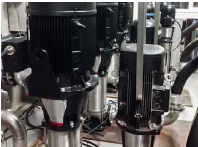
Testes da série CR95 – CR 185 no departamento de investigação e desenvolvimento da Grundfos.
