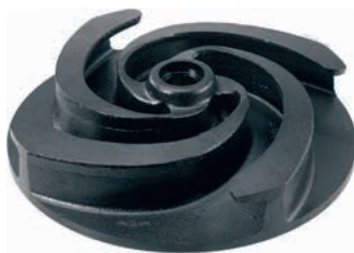
Вихревое рабочее колесо. Лопастные каналы предотвращают возникновение вторичных вихрей по краям колеса, повышая КПД насоса
