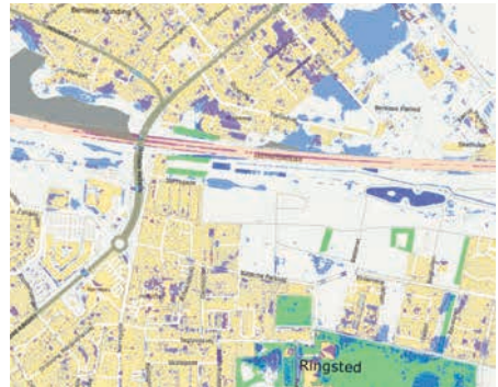
Карта развития обратного выброса, иллюстрирующая последствия аномального выпадения осадков. Участки, отмеченные синим цветом, были затоплены после сильного ливня
