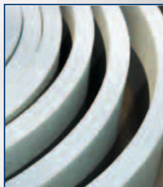
Дополнительная теплоизоляция (вспененный полиэтилен или теплоизоляционное покрытие Корунд)
