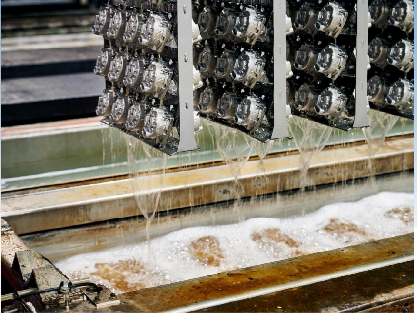
ชั้นวางชั้นงานเมมเบรนหล่อฉีดอินใหม่ทุกกลางด้วยน้ำจากบ่อสร้างรวมบ่อแรกในระบอบหมุนพิวเวเน CED ในโรงงานกรุนด์ฟอสในเมืองบเจอร์ริงโบ
